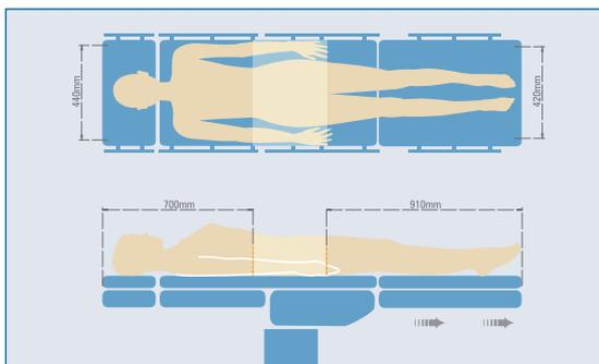
Las mesas quirúrgicas están diseñadas para lograr funciones de usos múltiples, eléctricamente accionadas e hidráulicamente operada a través de un control manual, control de pie (opcional), o control auxiliar (opcional). El marco de la mesa está hecha de aluminio fundido con base resistente al desgaste y las cubiertas de columna son de acero inoxidable para proporcionar resistente a impactos, roturas y desinfectantes.
